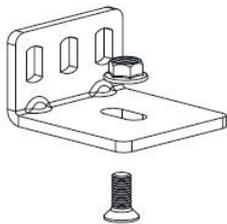
Compresa vite di fissaggio al binario.
