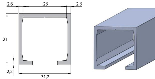
Misure fornite 2metri, 3metri, 4metri e 6metri, portata massima 120kg.
